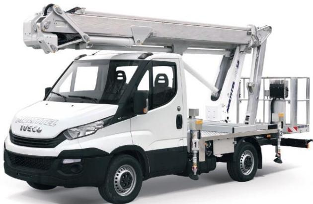
Piattaforma aerea articolata allestita su autocarro da 3,5 tonnellate, con altezza massima di lavoro di 25,10 m., sbraccio orizzontale massimo di 14,35 m e una portata in cesta di 80 kg e di 250 kg con lo sbraccio di 10,35 m.
