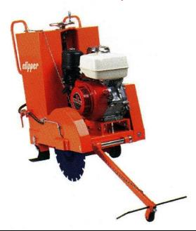
Motore Honda Benzina GX 390 con protezione in caso di mancanza d'olio
