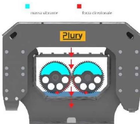
Vibrazione sinusoidale, vibra in modo verticale dall'alto verso il basso, concentrando la forza centrifuga al centro.
