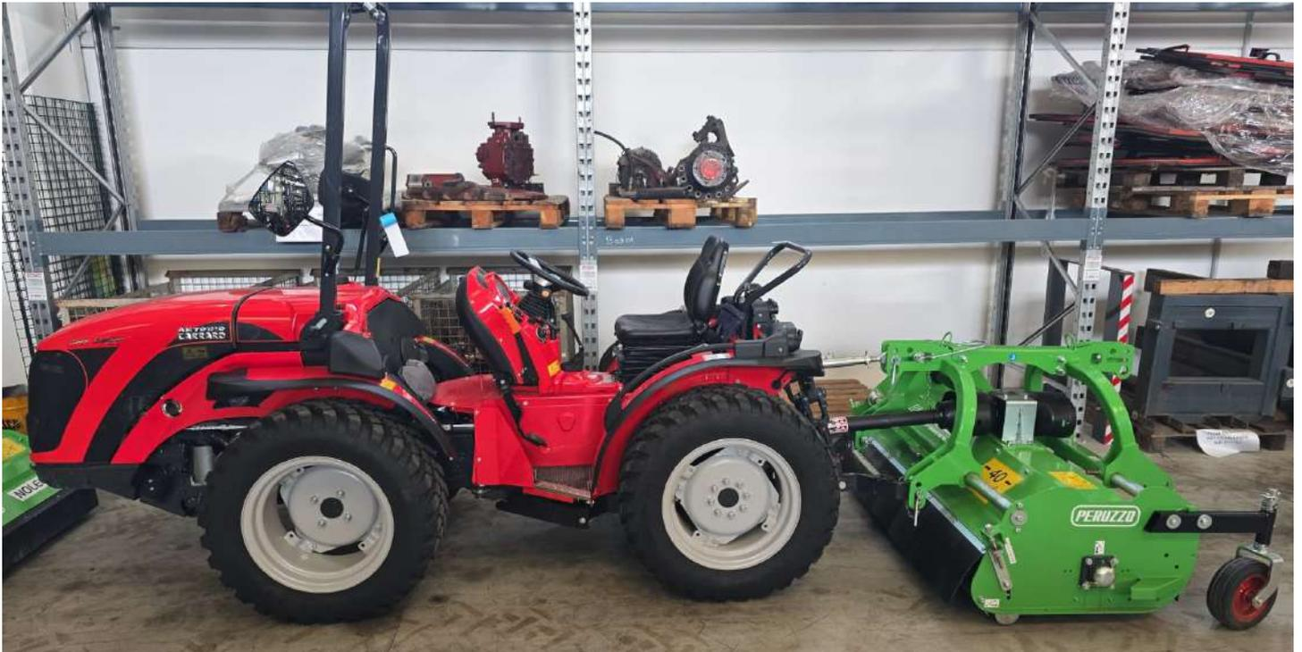
La trinciaerba ELK è adatta per l'applicazione a trattori da 35 a 55 CV di potenza e con attacco a 3 punti di categoria 1. Macchina reversibile: può essere applicata sia frontalmente che posteriormente al trattore.
