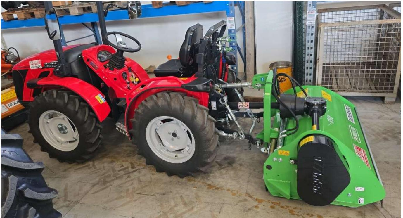
La trinciaerba posteriore FOX-S è stata progettata per l'esigenza di avere una trincia leggera per piccoli trattori, adattabile posteriormente, con attacco a 3 punti di categoria 1N.
