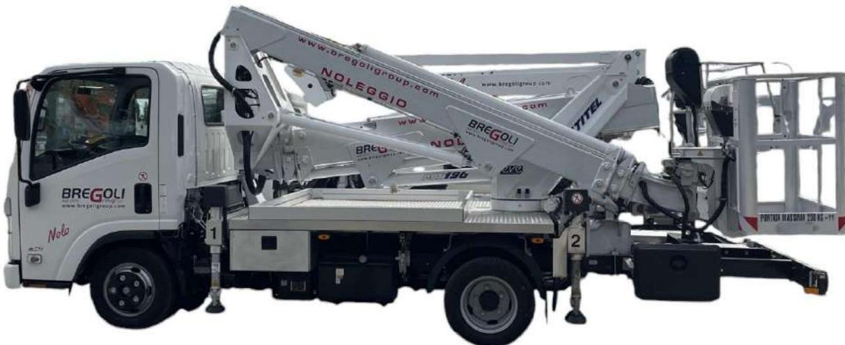
Piattaforma aerea articolata allestita su autocarro da 3,5 tonnellate, con altezza massima di lavoro di 19,60 m, sbraccio massimo orizzontale di 9,20 m e portata in cesta di 200 kg.
