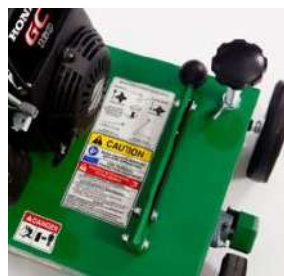
Monoscocca robusta costituita da un unico pezzo
